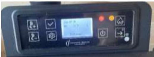
1. Après l'allumage, le message « CLEANING » apparaîtra. Le processus de nettoyage automatique (régénération) dure environ 5 à 15 minutes.
